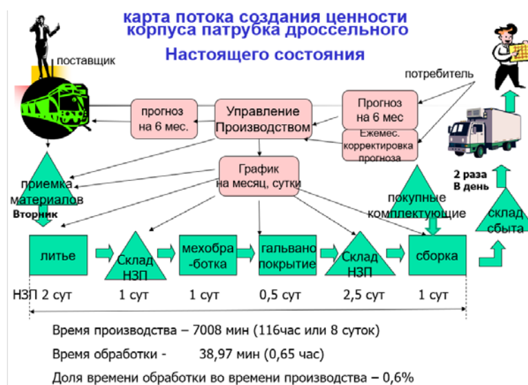
Рисунок 16 - Карта потока создания ценности патрубка дроссельного (текущее состояние трудового процесса по его изготовлению) 49
