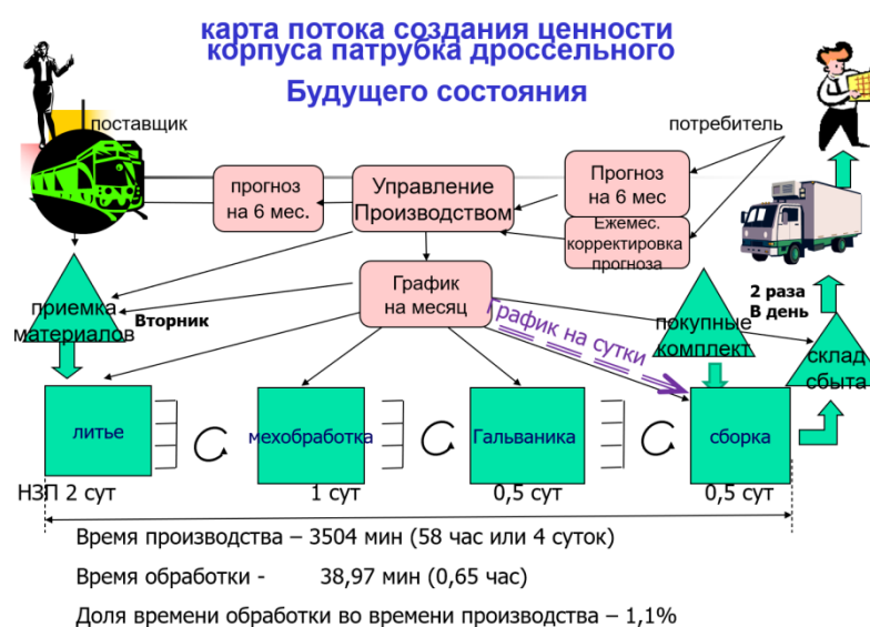
Рисунок 17 - Карта потока создания ценности корпуса патрубка дроссельного (будущее состояние) 51
