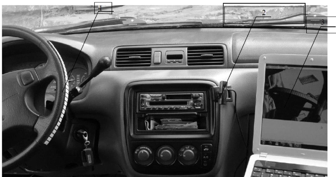
Рис. 1. Кабина легкового автомобиля с оборудованием для экспериментальных исследований по определению углов поворота рулевого колеса: 1 – шкала с делениями на руле автомобиля; 2 – видеокамера; 3 – записывающее устройство
